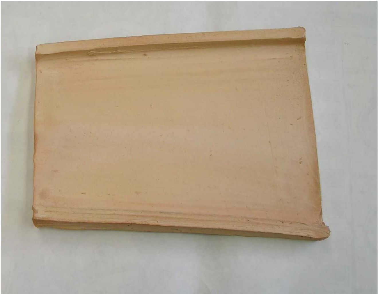
Figura 1. Riproduzione fotografica di un provino tal quale del prodotto “ Tegola in Cotto fatta a Mano ”.
