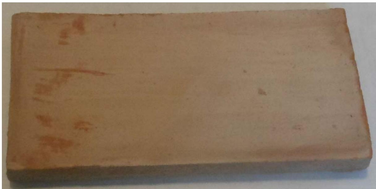
**Figura 1. Riproduzione fotografica della parte frontale (lato sabbciato) e del retro di un provino tal quale del prodotto “Tavella Finitura Grezza”.**
